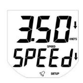
menu ボタンを押し、"SPEEd ↑"(スピード上限設アラーム定ページ)と画面に表示されるまで再度 menu ボタンを押して下さい。表示されたら ボタンで設定数値を調整して下さい。
